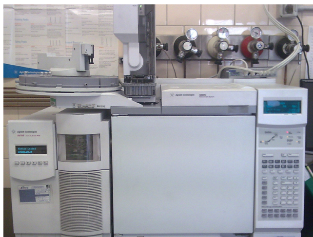
Figura 2 - Strumento per la gas-cromatografia accoppiato ad uno spettrometro di massa a singolo quadrupolo per l'identificazione di molecole, o miscele di molecole, contenute in campioni di diversa natura.
